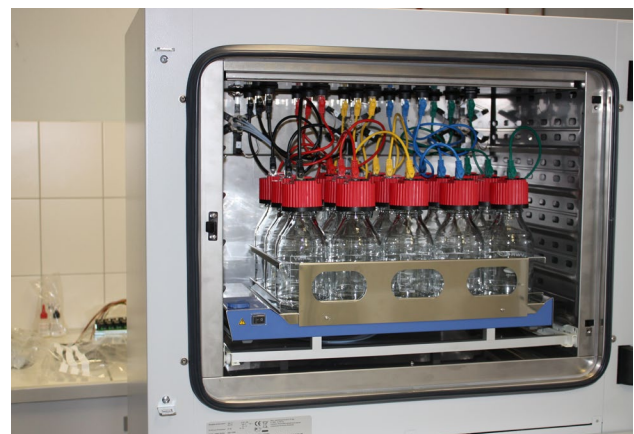
Testsystem der GMBU zur Bewertung von Substraten hinsichtlich Biogaspotential
